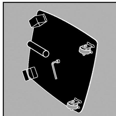
► Poser la platine ❷ sur le sol. ► Présenter la bille ❻ dans son logement. Poser vos lests ❸ sur la platine. ► Placer la barre de levage ❶ dans son logement (sous la platine) ❹ pour déplacer l'ensemble. ► Emboîter votre mât Funline dans l'embase.
